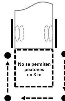
Camine al otro lado del camión manteniendo una distancia de 3 m por detrás de las puertas. Nunca se coloque directamente detrás de la parte trasera del camión con las puertas abiertas.
