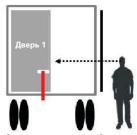
Снять ремень с двери 2. Открыть дверь, потянув на себя, таким образом, чтобы она оставлясь между вами и грузовиком. Проверить, нет ли наклонного груза за дверью 1. ОСТАНОВИТЬ работу, если груз упирается в дверь или наклонен.
